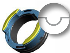
P.ej. Ø 1 mm con ranura en U (azul/amarilla): para aluminio
